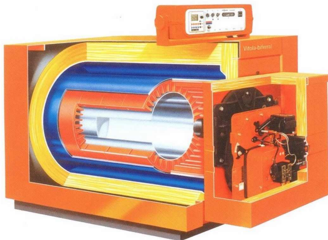
Figure 3 Réduction de pertes de chaleur par la méthode du gradient de température par couches successives, depuis le dard de la flamme à l'ambiance de la chaufferie.
